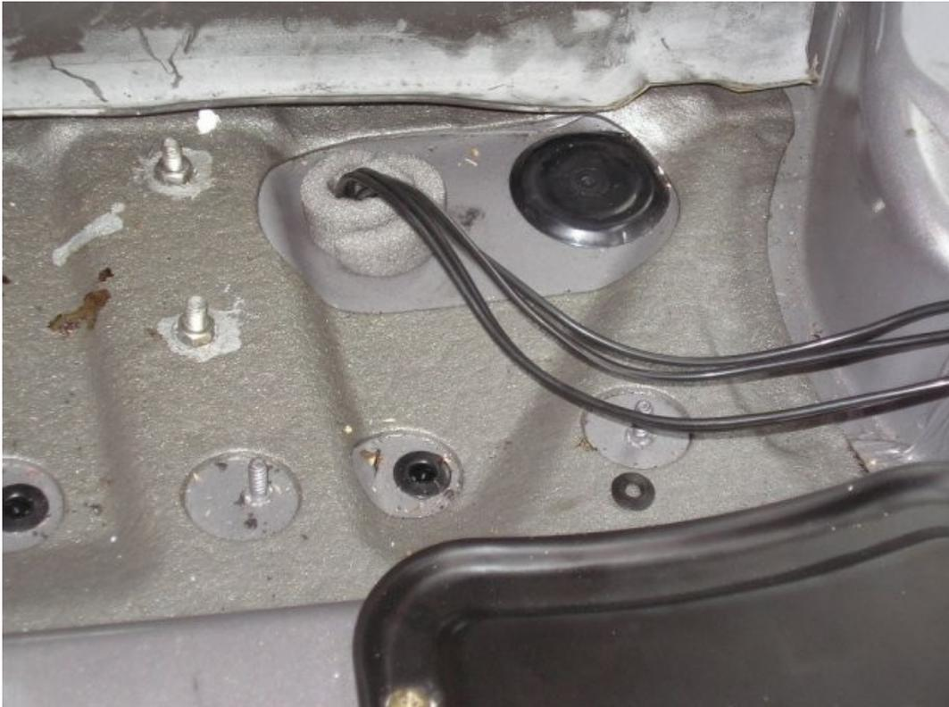
Links im Bild sind noch die Verschraubungen für die Facet zu sehen. Als Korrosionsschutz wurde reichlich Zinkfarbe mit in die Verschraubung geschmiert.
