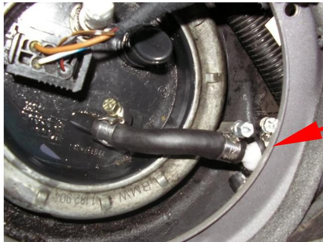
Die elektrischen Anschlüsse der Pumpen werden durch ein Loch im Bodenblech herausgeführt und hinten rechts an das VFP-Relais angeklemmt. Damit die Leitungen nicht beschädigt werden, wird das Loch mit Rohrisolierung für Heizungsrohre (Baumarkt) abgepolstert.
