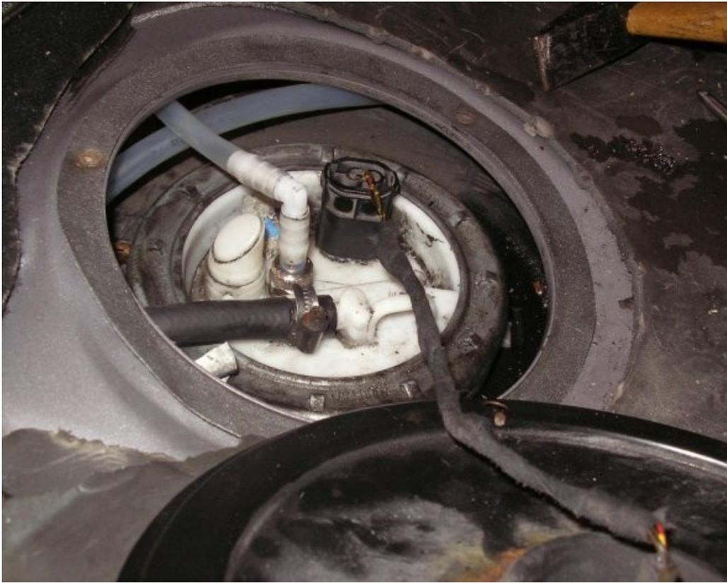
An der rechten Tankhälfte wird die Leitung von der Umpumpnpumpe mit einem Y-Stück mit dem originalen Rücklauf verbunden und in die rechte Tankhälfte eingespeist. Zugegeben, viel erkennt man nicht auf dem Bild, aber der Y-Verbinder unten rechts ist zu erahnen.
